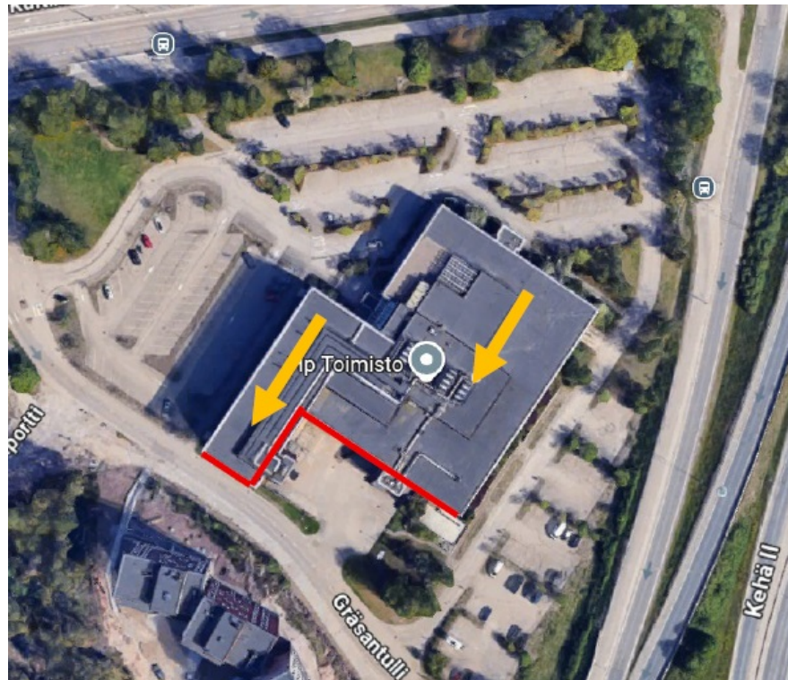
Kuva 1. Purkamisen eteneminen nuolilla. Punainen seinä puretaan viimeiseksi.
