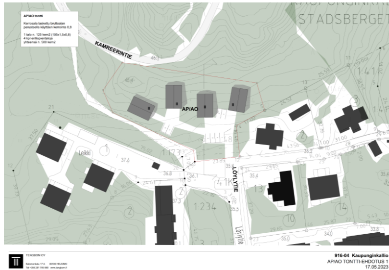
Kuva 32. Valmisteluaineisto: Asemapiirros alueen eteläosaan sijoittuvan pientalokorttelin vaihtoehdosta 1. Tässä vaihtoehdossa alueelle esitetään neljää erillispientaloa. Kuva ei mittakaavassa.
