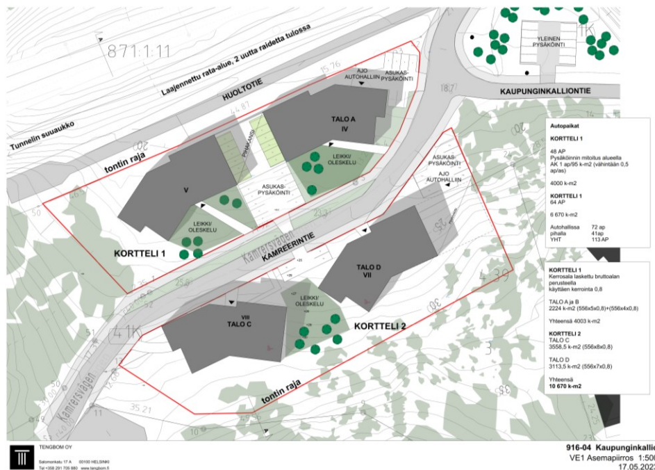
Kuva 29. Valmisteluaineisto: Asemapiirros alueen pohjoisosaan sijoittuvien kerrostalokorttelien suunnitelmavaihtoehdosta 1. Tässä vaihtoehdossa alueelle esitetään neljää asuinrakennusta ja asukas-pysäköinti sijoittuu pääosin rakennusten alle. Kuva ei mitataavassa.
