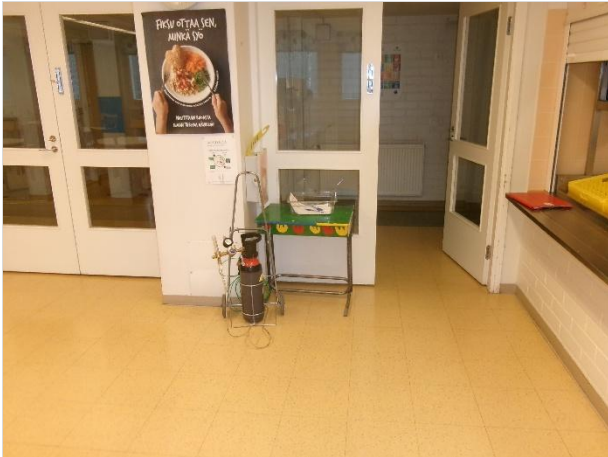
Kuva 62. Ruokasalin pystykoteloon laskettiin merkkiainetta.
