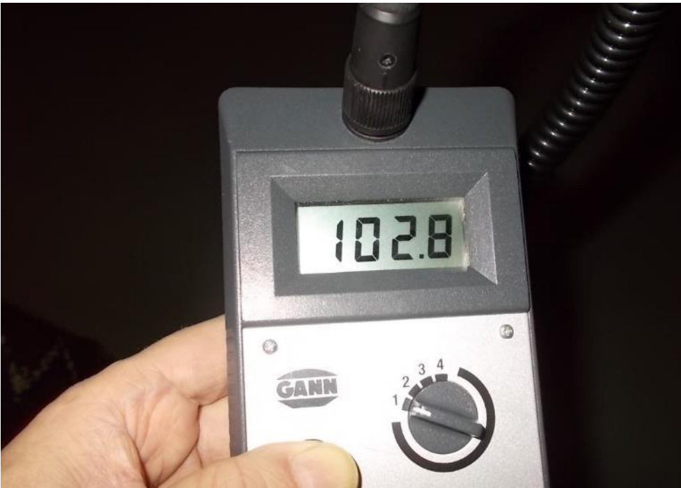
Kuva 4.10. Kellarikerroksen lattiassa on kosteutta.
