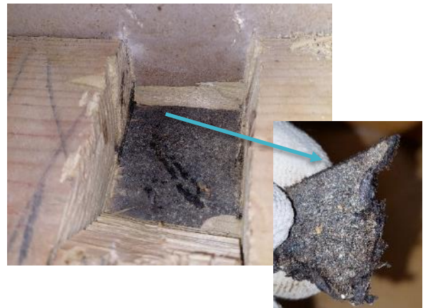
Kuva 86 Näyte 2 väliseinän avauksesta VS4. Ei sisällä asbestia eikä PAH-yhdisteitä.
