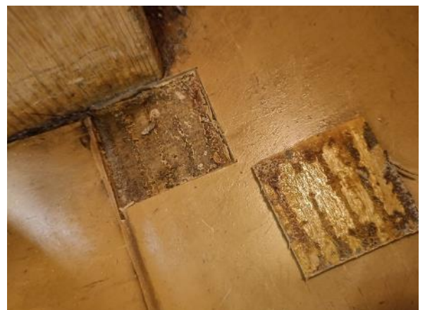
Kuva 88 Näyte 4. Siivouskomeron 1.61 vaaleanruskea muovimatto. Sisältää raskasmetalleja.
