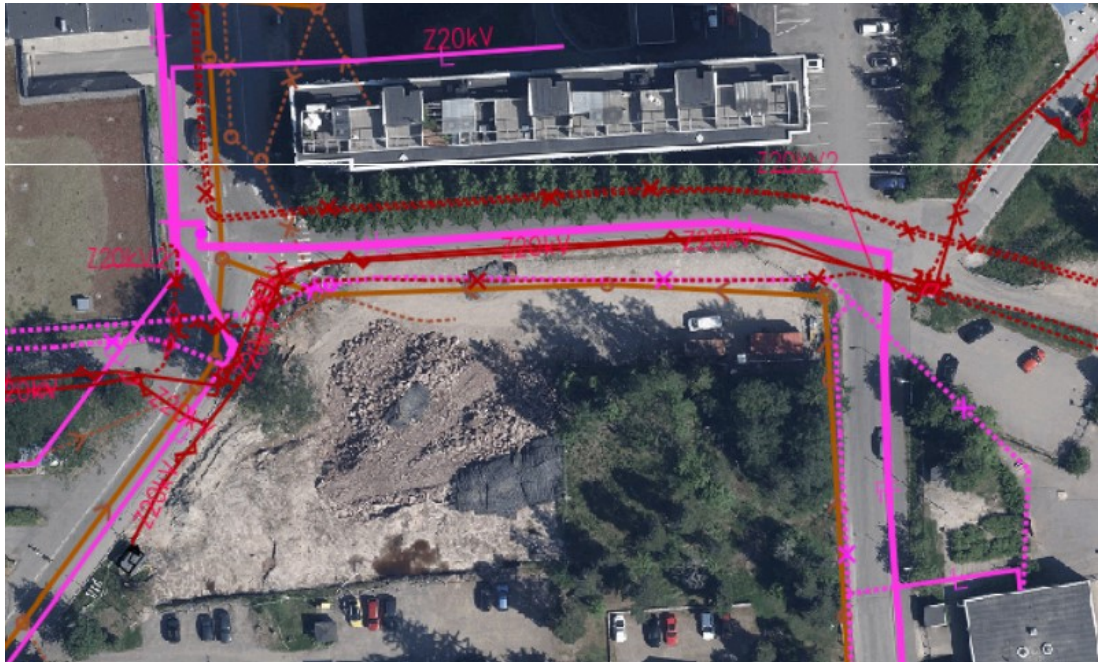
Kuva 27 Kaapelien sijainti Niittykujalla.
