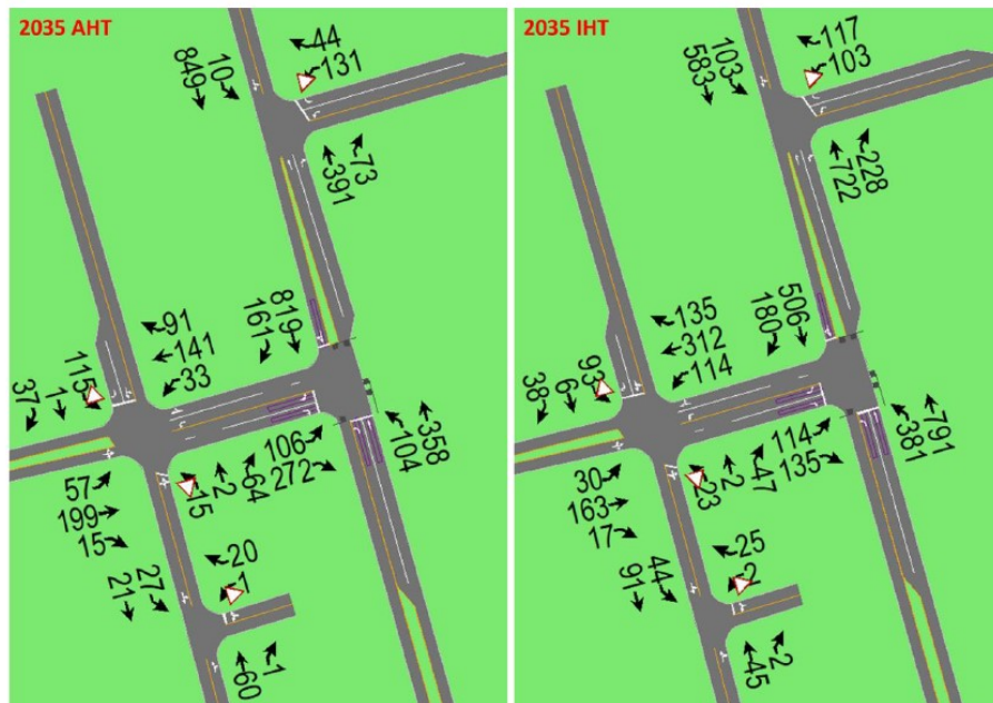
Kuvapari. Liikennemäärät huipputuntien aikana ennustetilanteessa 2035 (WSP, 12.9.2019).
