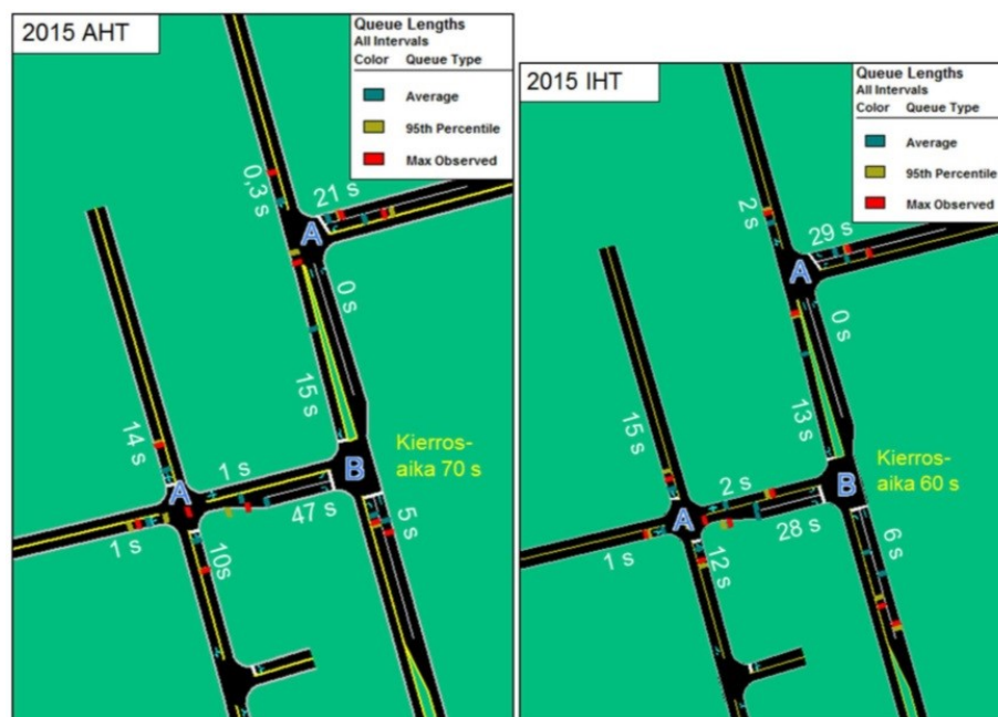
Kuva. Viivytykset (sekuntia), jonopituudet sekä palvelutaso tarkasteltavissa liittymissä vuoden 2015 aamu- ja iltahuipputuntien aikaan. WSP.
