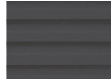
2c. MAALATTU URITETTU BETONI, TUMMANHARMAA
