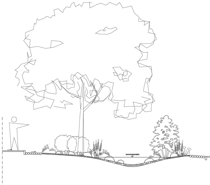
Kuva 19 Sadepuutarhan periaateleikkaus. Sadepuutarhassa on kasvillisuuden lisäksi painanne, joka toimii lammikoitumistilana.
