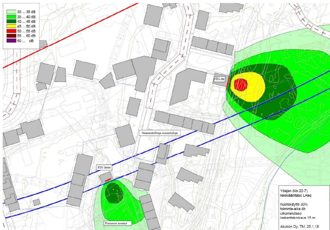
Kuva 32: Savunpoistopuhaltimien yöaikaisen huollon keskiäänitaso.
