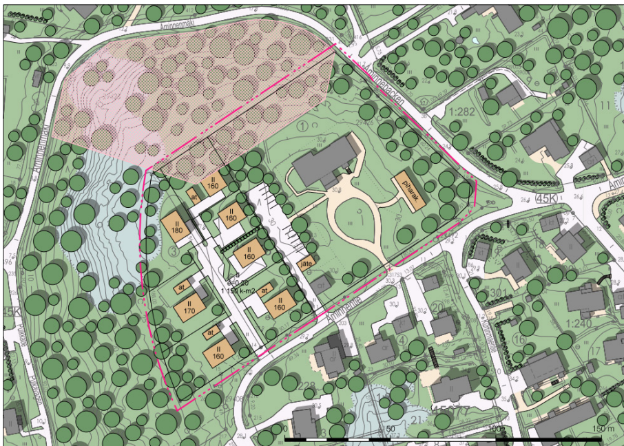
Kuva 22. Havainnekuva suunnittelualueen käyttötarkoituksen muutoksen mahdollistamasta uudesta rakentamisesta vaihtoehdossa 2. Kaava-alueen raja on esitetty punaisella pistekatkoviivalla. Nykyiset rakennukset on esitetty harmaalla ja mahdollinen uusi rakentaminen ruskealla. Vaaleanpunaisella rasterilla on esitetty muinaismuistoalueen sijoittuminen alu- eelle.
