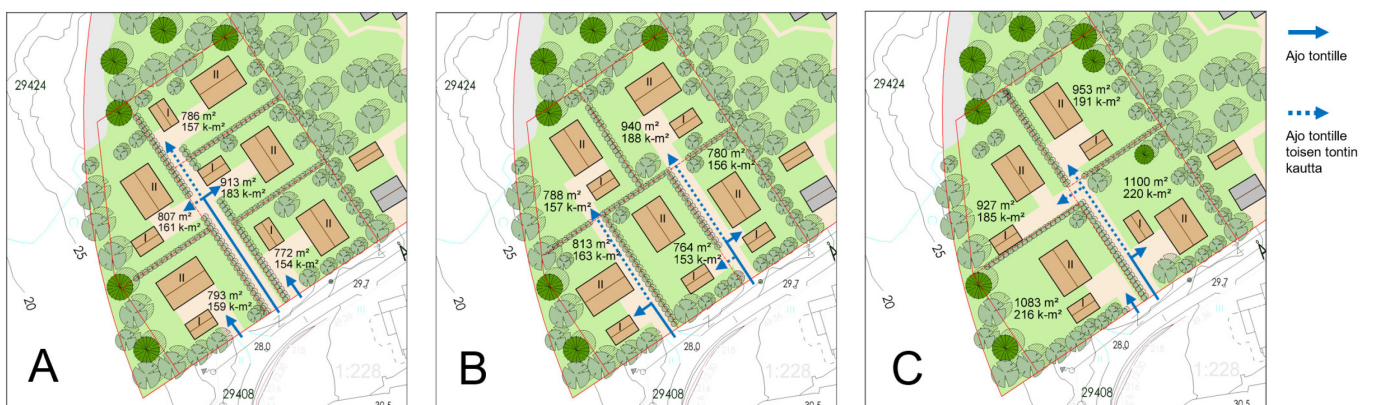
Kuva 18. Kolme vaihtoehtoista tapaa jakaa kaavaehdotuksen mukainen AO-kortteli tonteiksi. Vaihtoehdoissa A ja B tontteja on viisi ja ne ovat kooltaan 770–920 m 2 . Vaihtoehdossa C kortteli on jaettu neljäksi tontiksi ja kaksi tonteista on selkeästi muita tontteja suurempia, jolloin ne sopisivat hyvin myös paritaloille.
