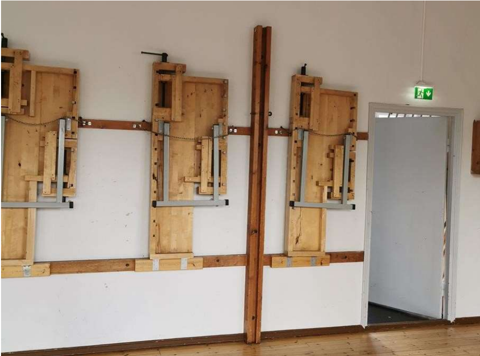
Liikuntasalin työstöpöydät seinälle käännettynä. Pöytien terävät reunat voivat olla turvallisuusriski lasten juoksennellessä salissa.
