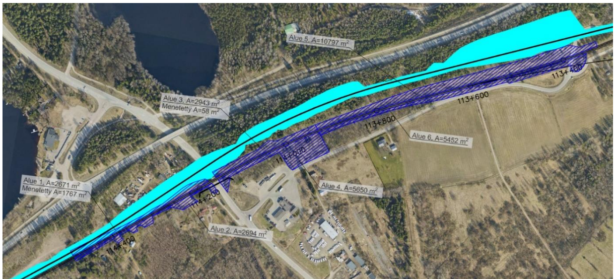
Kuva 10. Uusi vaihtoehtoinen linjaus. Turkoosilla värillä on merkitty linjauksen vaatima tila, joka jää raiteen rakenteiden alle tai leikkautuu pois. Sinisellä poikkiviivoituksella on merkitty uhanalaiselle perhoslajistolle ja niiden ravintokasveille tärkeät paahdealueet. Harmaissa laatikoissa on ilmoitettu paahdeympäristön pinta-ala neliömetreinä alueittain (ks. kuva 8) ja alemmassa tekstissä häviävän alueen pinta-ala.
