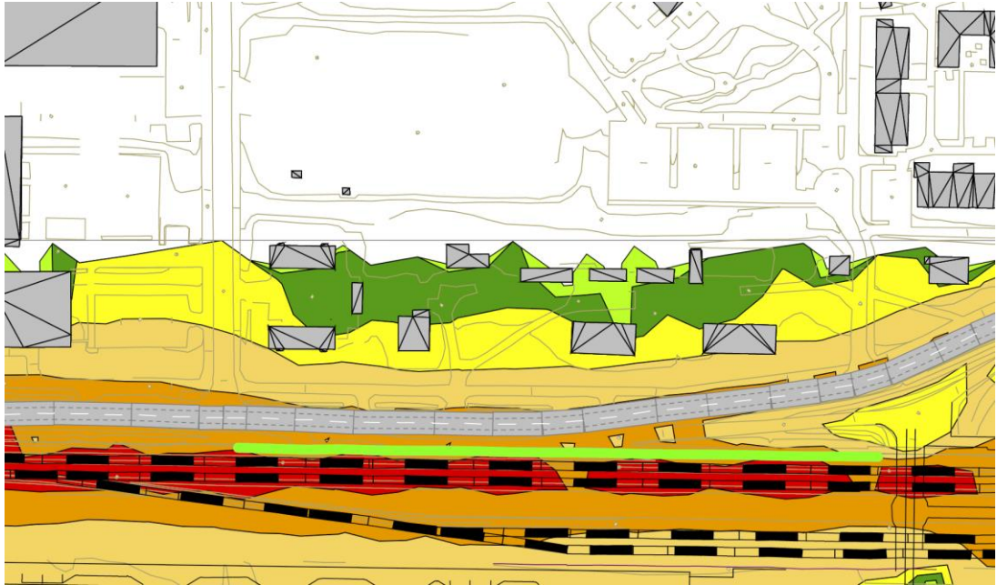
Kuva 6. Ote kaavoituksen aikana laaditusta melukartasta, jossa huomioitu radan eteläpuolella sijaitsevien rakennusten heijastemelu. Kuvassa on esitetty raideliikenteestä aiheutuva päiväajan keskiäänitaso. Vihreällä värillä näkyvät alueet, joilla melutaso on valtioneuvoston ohjearvon mukainen alle 55 dB. Ramboll 2021.
