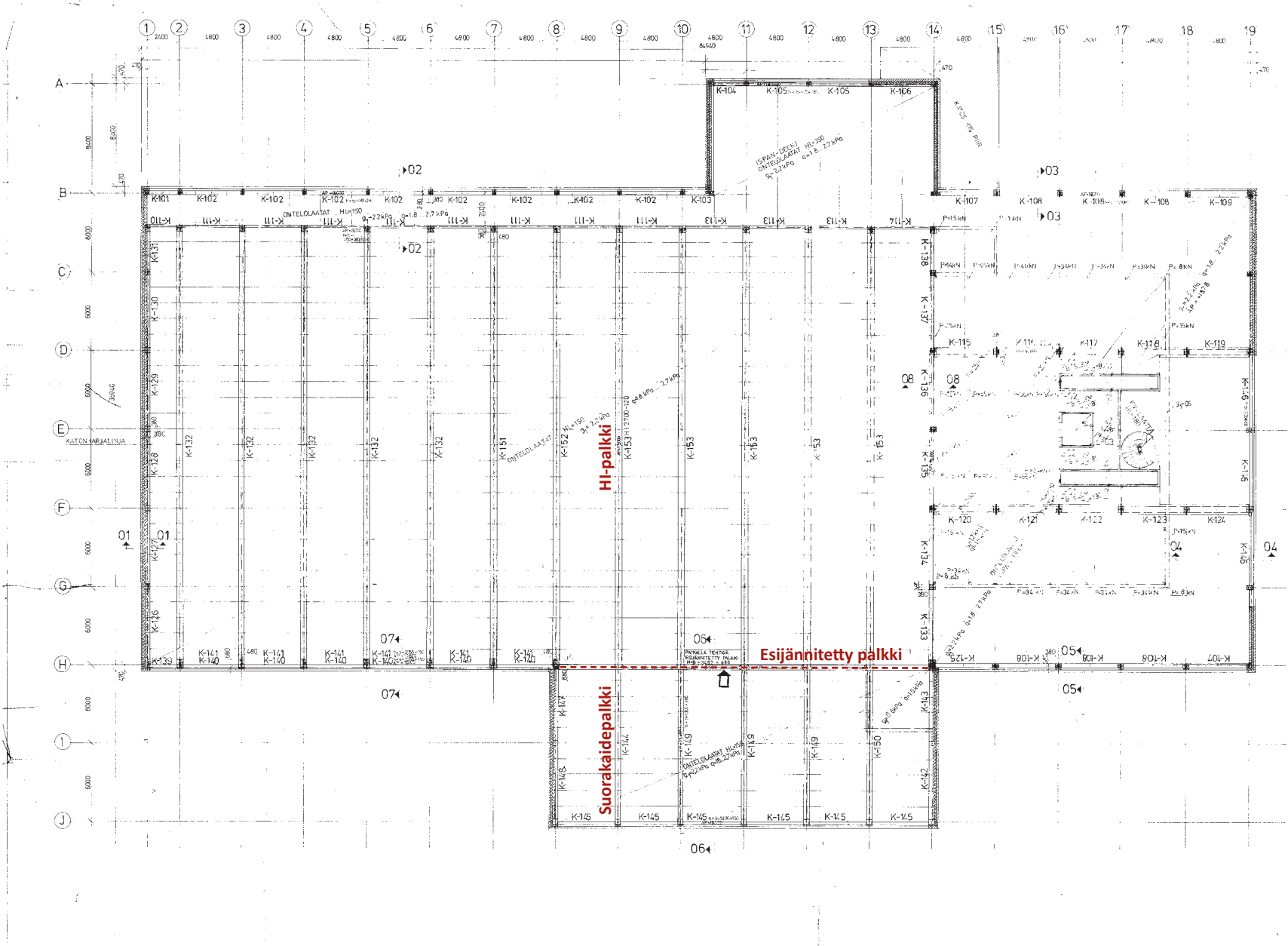
Yläpohjapalkit ja ontelolaatat.
